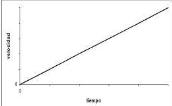
Velocidad en función del tiempo para un movimiento rectilíneo uniformemente variado.
